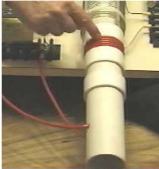
В качестве каркаса для L1 Дон использует пластмассовую трубу с таким диаметром, что намотав первичную на этот каркас, катушка могла бы войти и перемещаться внутри вторичной катушки. Поэтому, как видно из фото, провода подключения первичной катушки заведены внутрь трубы с достаточным зазором на поверхности каркаса для полного введения этой катушки во внутрь вторичной катушки.
