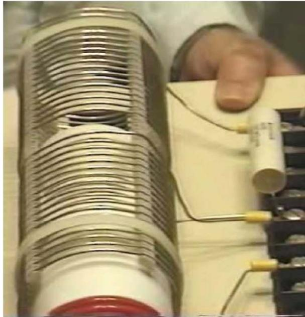
Такая конструкция может защитить катушку от возможного пробоя между витками, но надо иметь в виду, что межвитковый зазор влияет на характеристику катушки, меняя ее режим накопления заряда с индуктивного на емкостной. Меняется отношение LCR .
