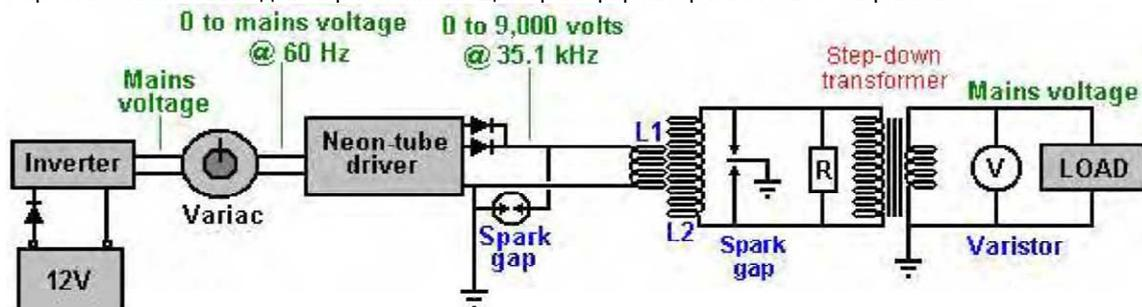
Здесь не нужны высоковольтные конденсаторы и напряжение на выходе L2 не выпрямляется.
