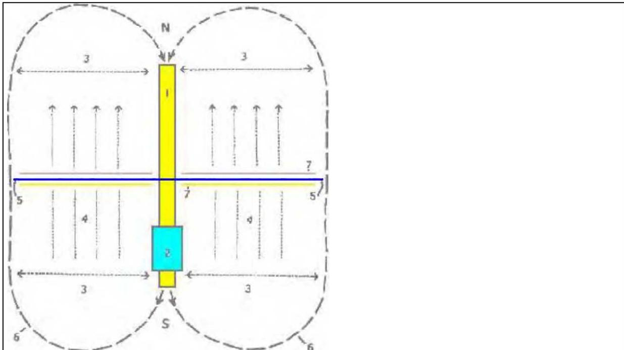
На рисунке отмечен диполь 1 с полюсами, 2 – резонирующая высоковольтная катушка индуктивности, 3 – электромагнитная эмиссия от диполя, 4 – положение и направление потока соответствующего мощного токового компонента энергии от катушки индуктивности (2). 5 – диэлектрик между пластинами конденсатора 7. В целях пояснения на рисунке показаны линии энергии электромагнитной волны 6.
