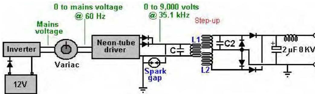
Питание устройства - от батареи 12в (не установлена на панели). Дон отмечает, что если длина проводов подключения батареи к DC/AC инвертору выдержана точно 1/4 длины волны осциллирующего магнитного поля (в данном случае частота напряжения накачки 35,1 кГц), то в этих проводах наводится достаточно тока, чтобы постоянно заряжать батарею (даже если она подключена и питает инвертор).
