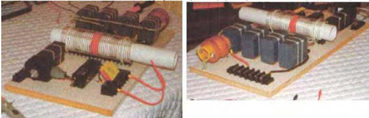
Опять же, устройство небольшое, простой конструкции. Однако некоторые компоненты не показаны на фото - некоторые смонтированы отдельно: батарея 12В, кабель подключения питания и заземления, ЛАТР, понижающий (выходной) трансформатор и варистор (для ограничения бросков выходного напряжения), но подробное описание приводится ниже.
