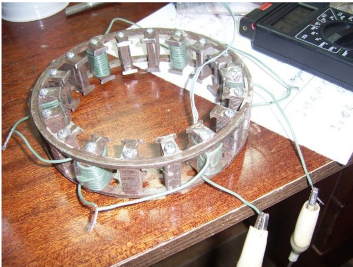
Фото 4. После окончательной сборки всех кернов мотаем на каждой фазе (один керн через два, как в родном Г-250) встречно-бифилярные обмотки многожильным проводом в хлорвиниловой изоляции до заполнения (получилось два по шесть витков).
