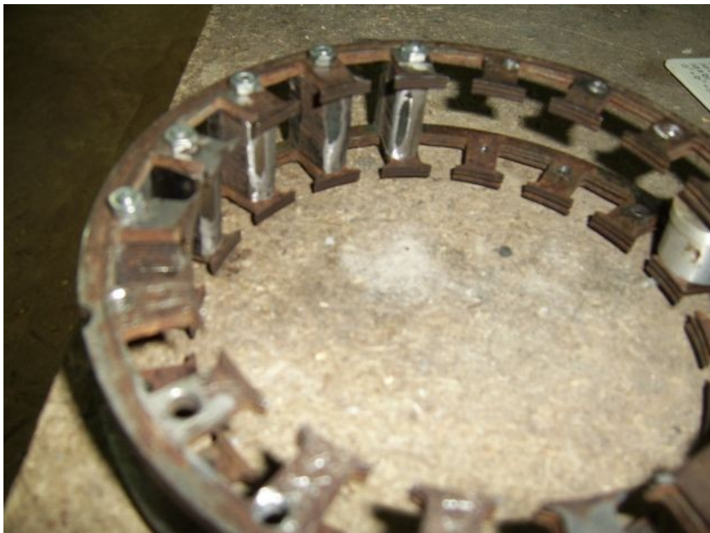
Фото 4. После окончательной сборки всех кернов мотаем на каждой фазе (один керн через два, как в родном Г-250) встречно-бифилярные обмотки многожильным проводом в хлорвиниловой изоляции до заполнения (получилось два по шесть витков).
