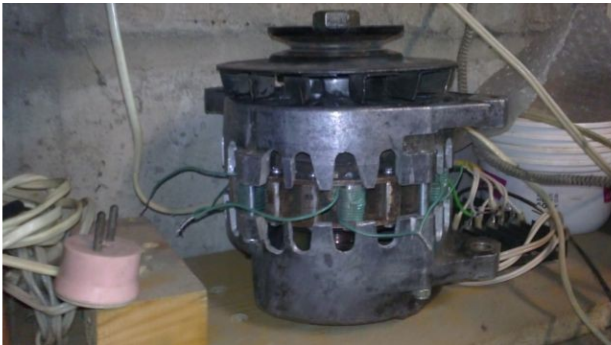
Фото 5. Собираем генератор назад (пока только с одной фазой).
