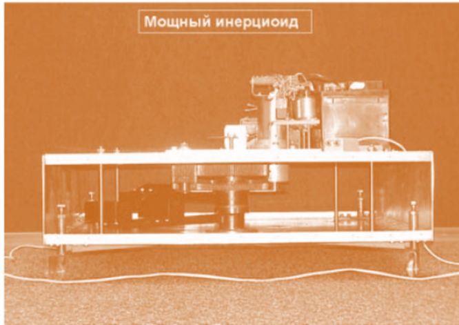
Рис. 2. Мощный инерцоид с тягой в импульсе 11 кг.
