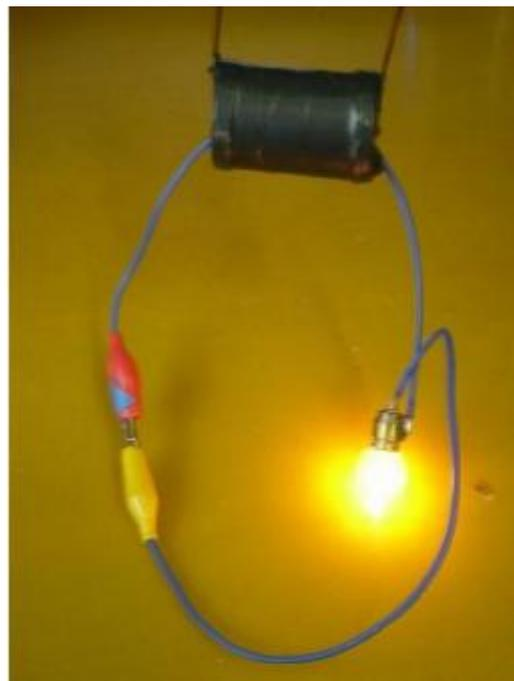
На первых двух фото – сердечник из медной трубки  $D=16$  мм,  $L=80$  мм. Этот же стержень является вторичной обмоткой  $W2$ , т.е. с его торцов снимается выходное напряжение. На второй и третьей фотографии – сердечники в виде массивного шестигранного железного стержня  $D=14$  мм. и в виде длинного стального стержня  $D=10$  мм. На следующих фото - в качестве сердечника используется обыкновенная отвертка и сердечник в виде провода. Частота питающего напряжения – 20...200кГц.
