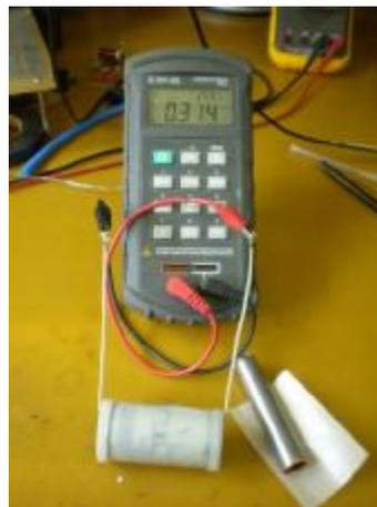
4. Введение в «трубку – W2 – сердечник» ферритового стержня не вызывает никакой реакции ни при каких режимах. Кроме того, размещение внутри первичной обмотки нескольких вложенных и изолированных друг от друга трубок демонстрирует полную их независимость. Каждая из трубок ведет себя так, будто она – единственная. Не зависимо от протекания тока по другим, внешним или внутренним трубкам. И напряжение на них абсолютно одинаковое. Аналогичная ситуация с группой стержней в качестве вторичной обмотки.
