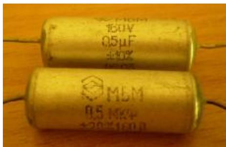
Берем два неполярных конденсатора, в частности я использовал МБМ 0.5 мкФ 160В. Мотаем «хитрую обмотку», идентичную первичной обмотке ХТ. Обмотку размещаем на полиэтиленовом каркасе и, для пущей важности, обматываем изоляционной лентой. В середину получившегося тороида вставляем вышеуказанные конденсаторы. У меня каркас получился чуть меньше, чем сумма диаметров корпусов конденсаторов, поэтому обмотку несколько сжать.
