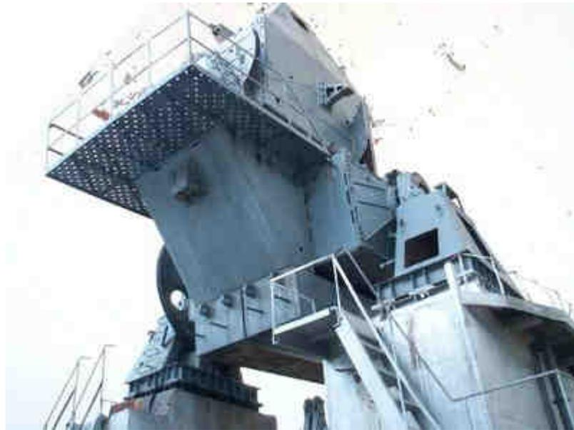
Остатки опорно-поворотного устройства антенн радиолокатора канала изделия внутри радиопрозрачного купола.
